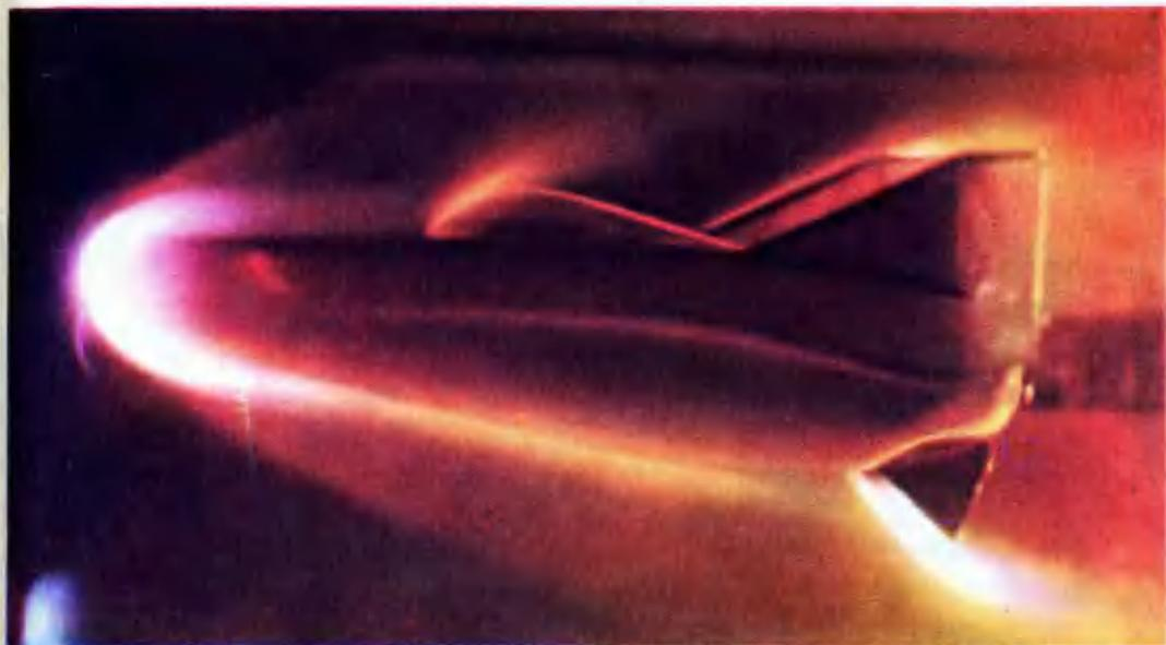
На верхнем снимке — испытания в аэродинамической трубе модели самолета без крыльев для сверхвысотных полетов. Воздух, обтекающий модель со скоростью 430 м/сек, раскаляется до 4500°С.
